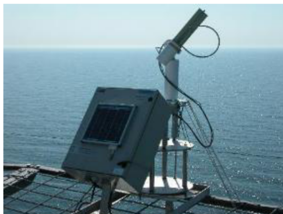
Radiometru oceanic instalat la Platforma "Secția 7"
